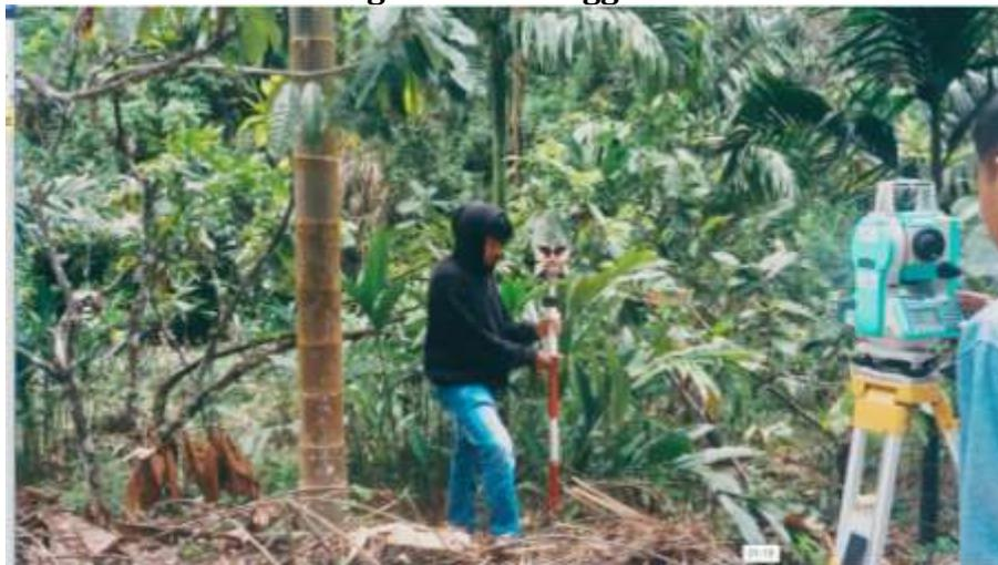
**Gambar 11. Pengukuran Menggunakan Theodolit**
