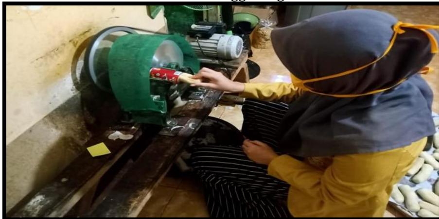
Gambar 5 Proses pemotongan adonan
