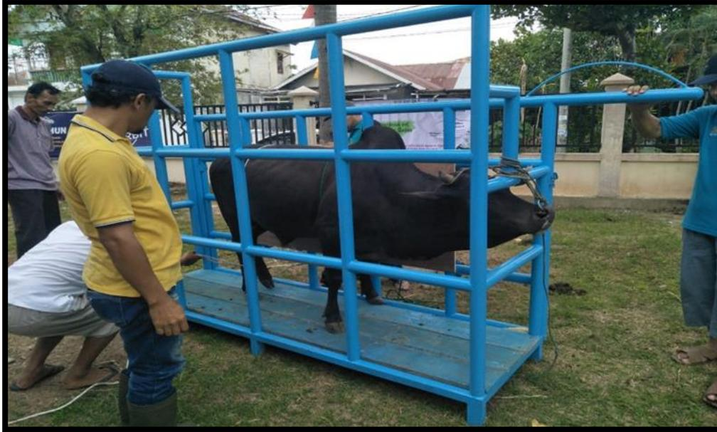
**Gambar 2.** Memasukkan sapi ke bagian tengah alat dan menguncinya
