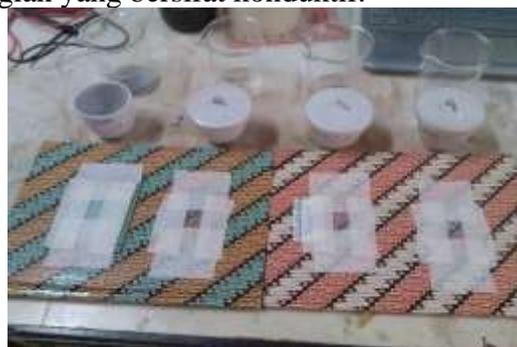
**Gambar 2.** Semikonduktor Yang Akan Diaplikasikan Pada Elektroda Kerja
