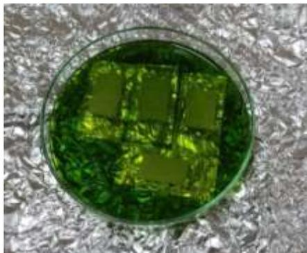
**Gambar 4.** Perendaman semikonduktor yang telah dideposisi pada permukaan kaca TCO kedalam larutan *dye*
