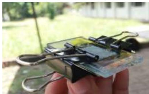
**Gambar 6.** Prototipe DSSC dalam bentuk *sandwich*
