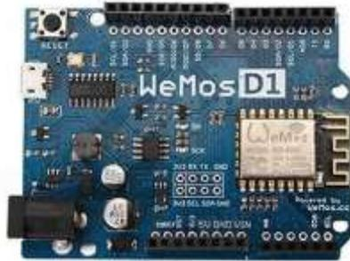
Gambar 2. Board WeMos-D1R2 yang berbasis ESP8266
