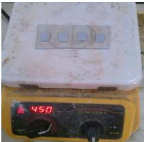
**Gambar 3.**Elektroda kerja yang disintering pada suhu 450°C
