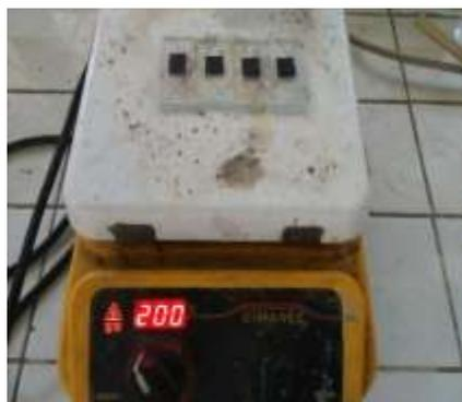
**Gambar 5.** Pendeposisian grafit sebagai *counter electrode*
