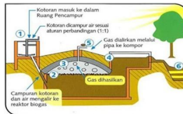
Gambar 22. Contoh pengolahan kotoran sapi menjadi biogas (Sumber gambar ilustrasi: google)
