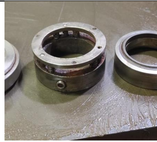
Sparepart Mech. Seal yang baru
