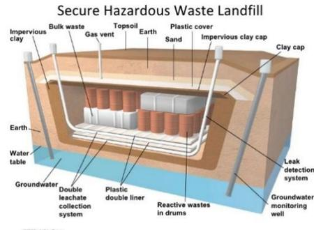
**Gambar 2. Gambar untuk Penimbunan Aman (*Secured Land Filling*)**
