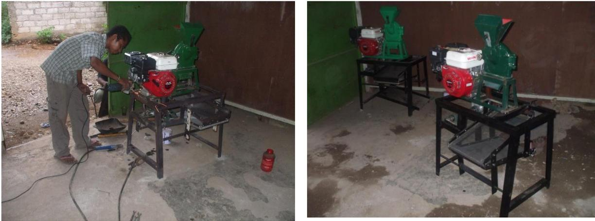
**Gambar 2. Proses pembuatan alat penggiling jagung dengan 3 tingkat kehalusan.**
